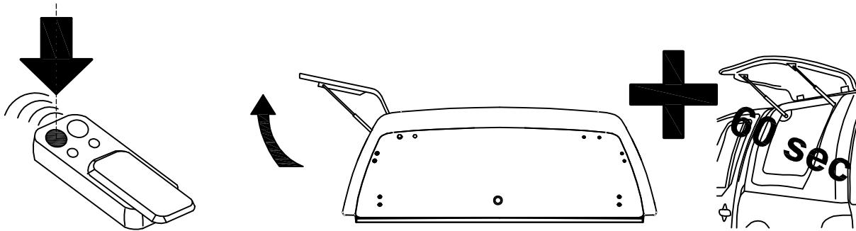
Beim oeffnen der Seitenklappe schaltet sich die Innenleuchte automatisch fuer 60 sekunden ein.
